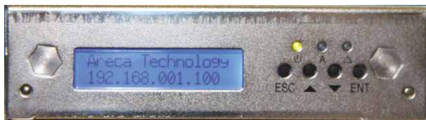
LCD zur Bedienung und Statusabfrage (Rückseite, von Oben)
